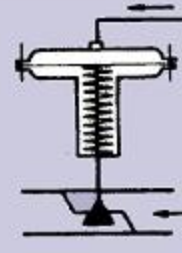
FIG. 9 667R (NC) - Normal Cerrada - Aire a abrir - Resorte cierra - Flujo a abrir - Solo orificios 16 a 35
