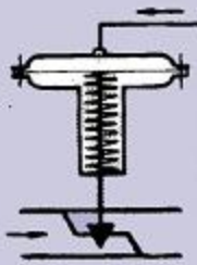
FIG. 7 657R (NA) - Normal Abierta - Aire a cerrar - Resorte abre - Flujo a abrir
