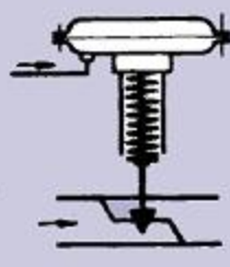
FIG. 8 667R (NC) - Normal Cerrada - Aire a abrir - Resorte cierra - Flujo a abrir - Solo orificios 5 a 13
